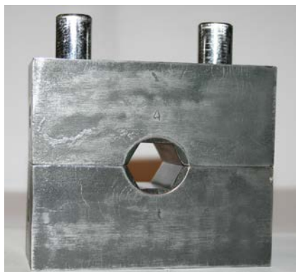
Рис. 7. Общий вид пресс-матрицы для опрессовки оконцевателей полимерных линейных изоляторов ЛК70-35
